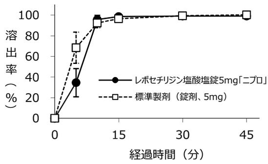
図1-1 試験液 : pH 1.2 (50 rpm)
